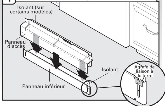
Vérifier que l'agrafe de liaison à la terre est fixée sur le panneau inférieur. Placer le panneau inférieur derrière le panneau d'accès. Sur certains modèles, il y a sur le panneau d'accès un matériau isolant qui devra être inséré derrière l'isolant du panneau inférieur.
